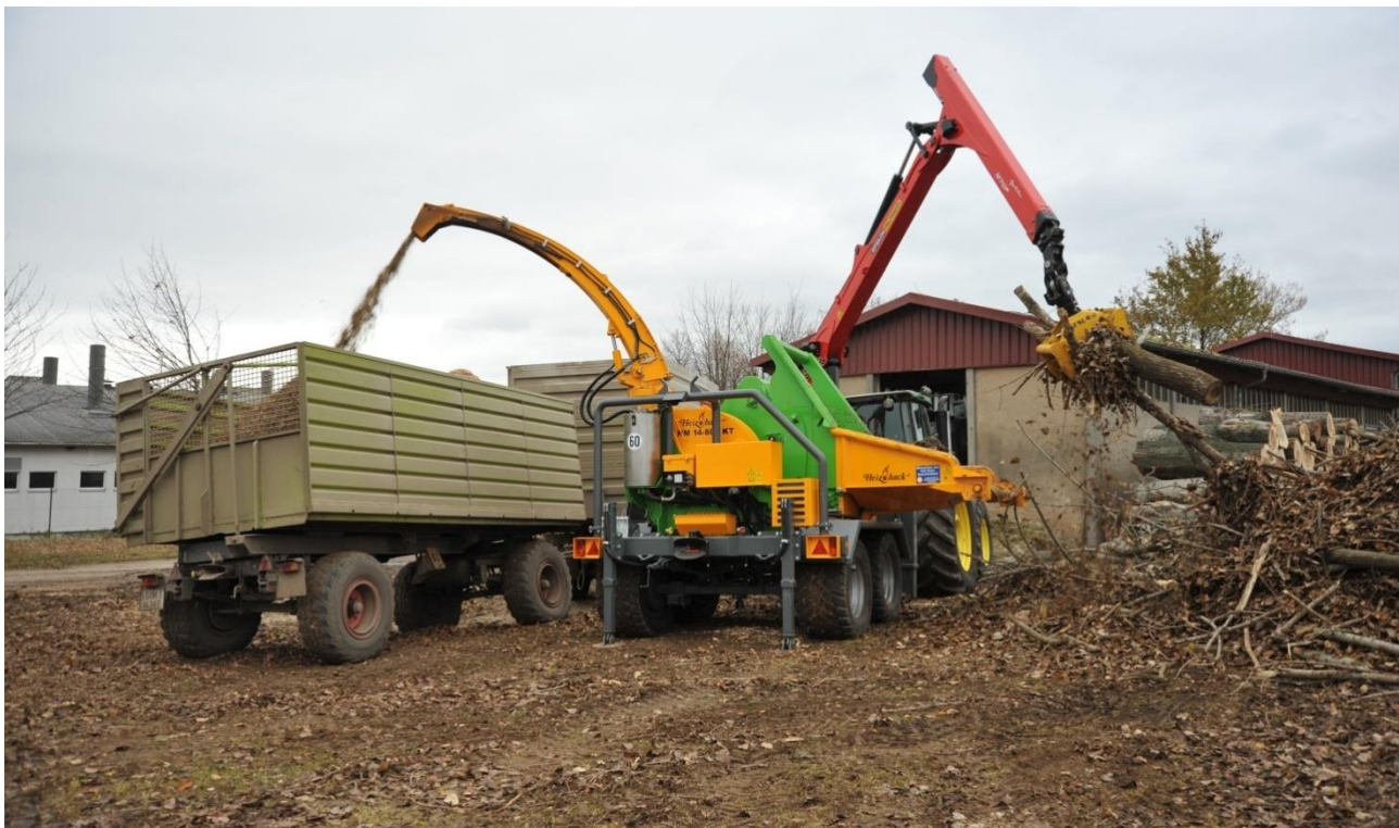
Abbildung 5.1 Aufbereitung von Waldrestholz zu Holzhackschnitzeln (© DBFZ).
