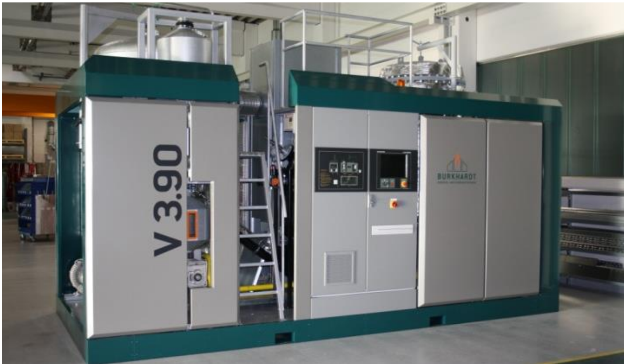
Abbildung 7.5 Holzvergaser Burkhardt GmbH 180 kW el (© Burkhardt GmbH).
