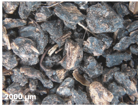
Abb. 4.11: Stereomikroskopaufnahme von Gärreste (TK-1480), Zerkleinerungsgrad: HM SLW 4 mm
