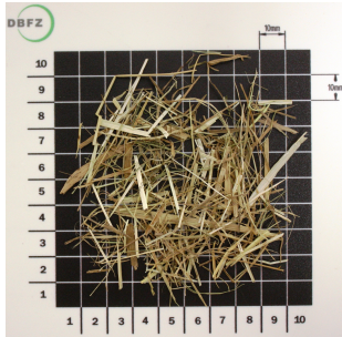
Abb. 4.1: Grob zerkleinertes Heu als Basismaterial, Zerkleinerungsgrad H SLW 25 mm
