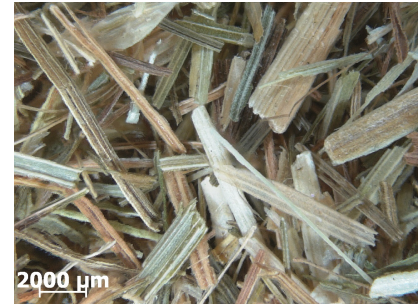
Abb. 4.3: Stereomikroskopaufnahme von Heu (TK-1164), Zerkleinerungsgrad HM SLW 4 mm
