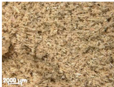
Abb. 4.35: Stereomikroskopaufnahme von Heu (TK-1164), Zerkleinerung mittels Stabschwingmühle (Pulver)
