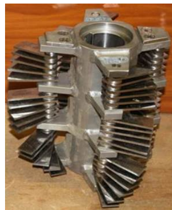
Abb. 3.5: Rotor der Hammermühle mit schmalen Schlägern ( 3 \text{ mm} )
