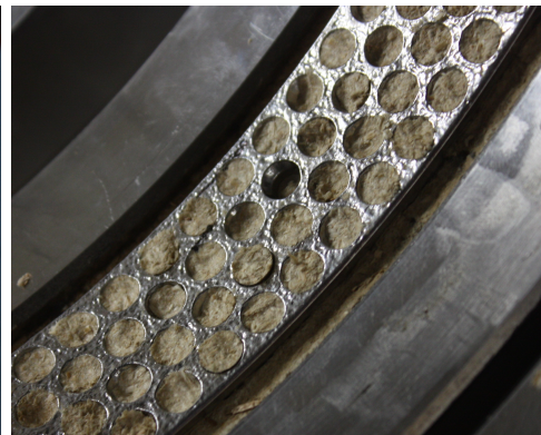
Abb. 2.10: Verschleißerscheinungen an einer Ringmatrize - eingeschlifene Kollerlauffläche (Durchmesser Matrizenbohrungen 6 mm, Breite der gelochten Lauffläche 38 mm)
