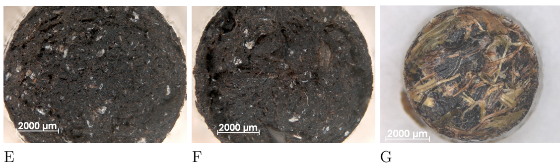
Abb. 4.30: Stereomikroskopaufnahmen der Bruchflächen von Einzelpellets aus Gärresten (TK-1480) bei \vartheta_V 40 (E) bzw. 120 °C (F) und aus der 50 Ma.-%igen Mischung von Heu und Gärresten bei \vartheta_V 120 °C (F) ( w 20 \pm 0,5 Ma.-%, Zerkleinerungsgrad: HM SLW 4 mm)
