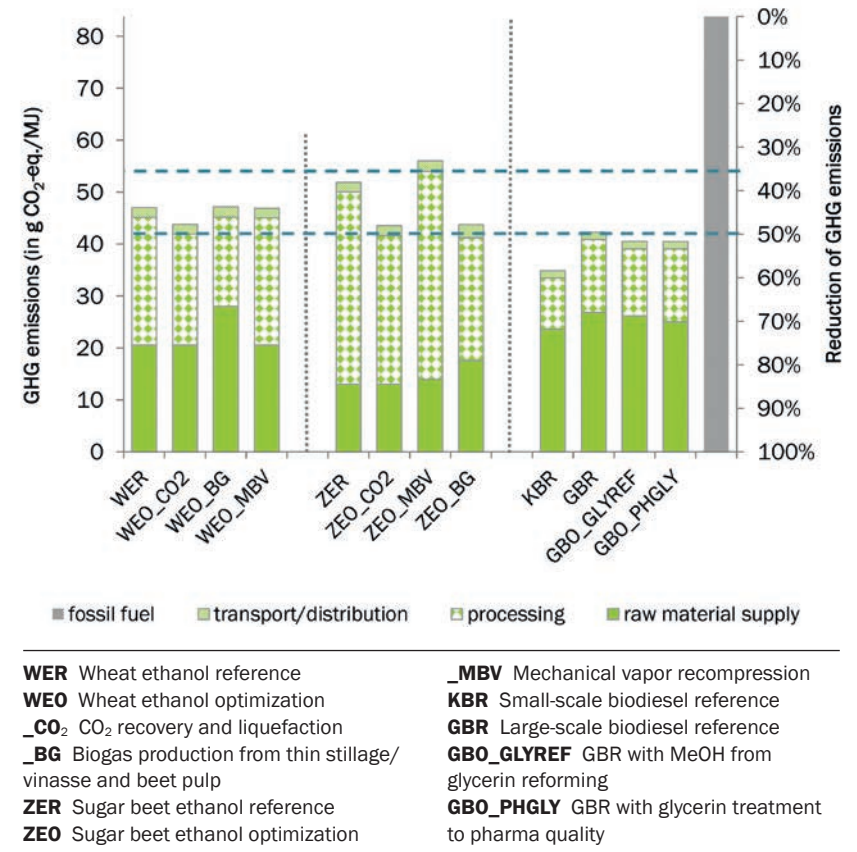
Abb. 10 THG-Minderungspotenzial von Biokraftstoffen mit den untersuchten Optimierungsansätzen gegenüber Referenzanlagen und fossilen Kraftstoffen
