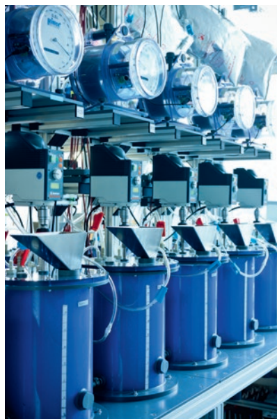
Abb. 61 Volldurchmischte Rührkesselreaktoren im Biogaslabor des DBFZ
