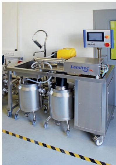
Abb. 64 Neuer Dekanterprüfstand im Kraftstofftechnikum des DBFZ
