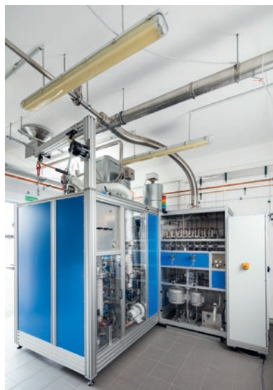
Abb. 63 Festbettvergaser im Kraftstofftechnikum des DBFZ
