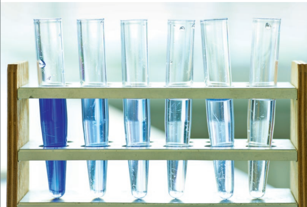
Abb. 45 Proteinbestimmung (Lowry) im Biogaslabor des DBFZ
