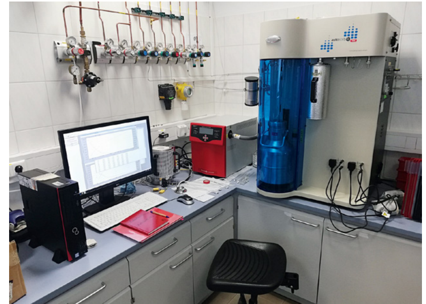
Abb. 14 Apparatur zur Charakterisierung von Festkörpern (Pulver und Monolithe) mit Methoden der Physi- und Chemisorption.
