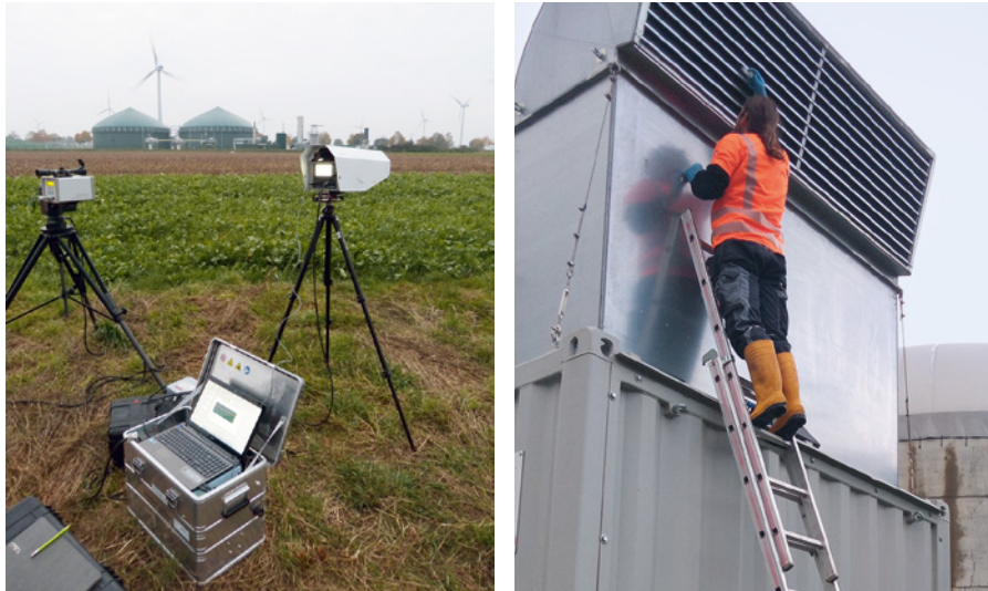
Abb. 7 Emissionsmessungen an einer Biogasanlage mittels Fernmessmethode (l.) und On-Site Methode (r.)
