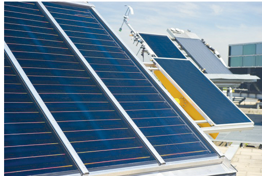
Außenteststand des TestLab Solar Thermal Systems des © Fraunhofer ISE
